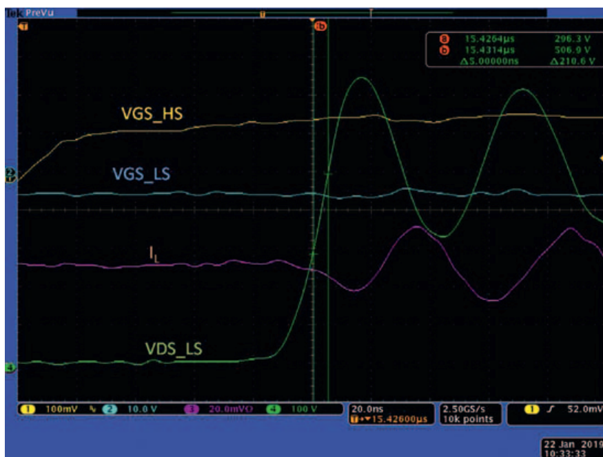
Bild 3: Einschalten mit dem Gate-Treiber CMT-TIT8243 und dem Leistungsmodul CAS300M12BM2 bei einem du/dt von über 40 \text{ kV}/\mu\text{s} [2].
