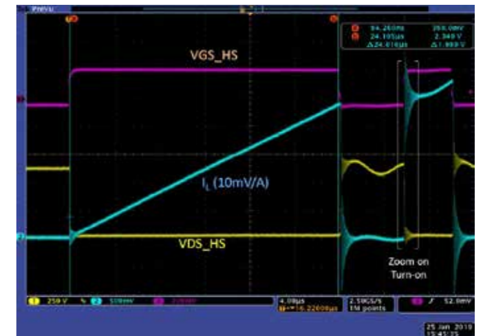
图 4. CMT-TIT8243 栅极驱动器和 CAS300M12BM2 模块 [5] 的双脉冲开关信号。
