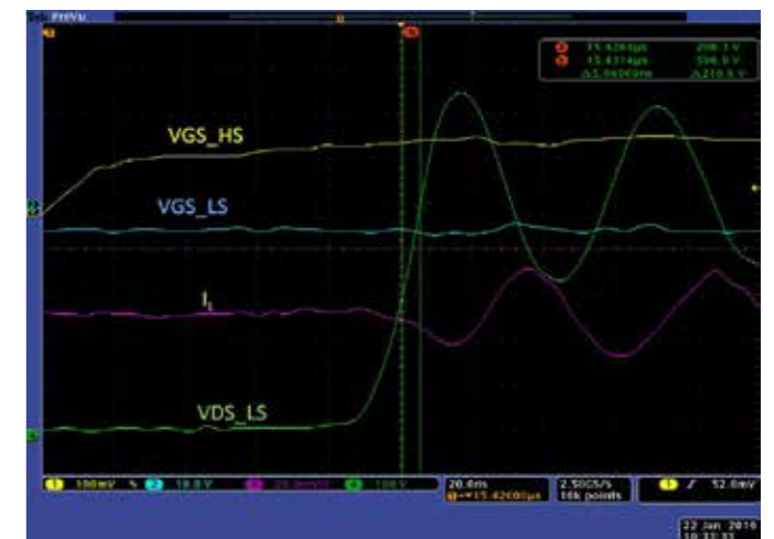
图 5. 开启时 dv/dt > 40KV/\mu s , CMT-TIT8243 高温高压隔离栅极驱动器和 CAS300M12BM2 模块 [5]
